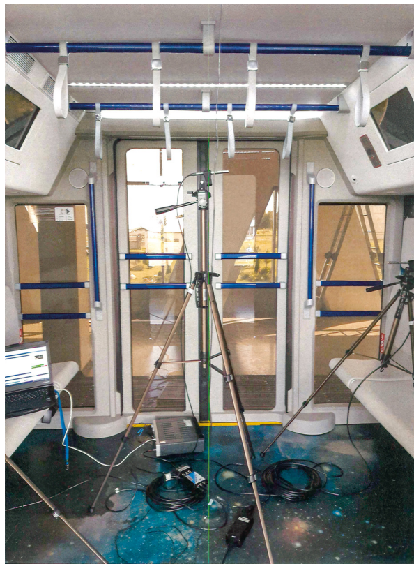
Рис. 10. Размещение микрофонов в салоне юнибуса
