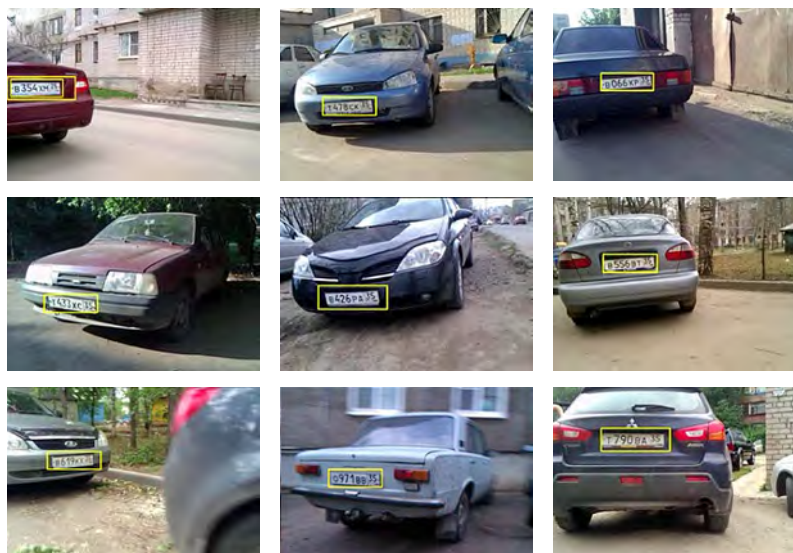
Рис. 2. Автомобильные номера, обнаруженные каскадом Хаара
