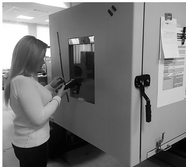
Испытания метки в климатической камере
