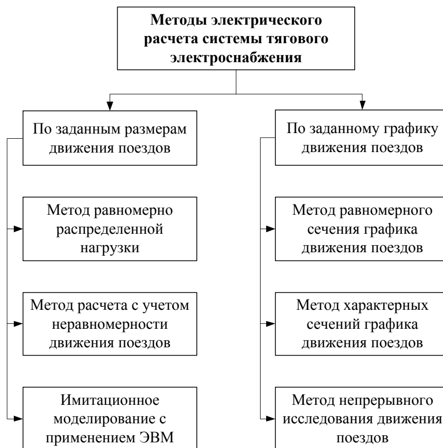
Рисунок 1.7 – Методы электрического расчета системы тягового электроснабжения
